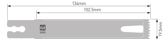
MODEL HCR-101HB (Толщина : 1.20mm) MODEL HCR-101HC (Толщина : 1.27mm) MODEL HCR-101HD (Толщина : 1.40mm)
